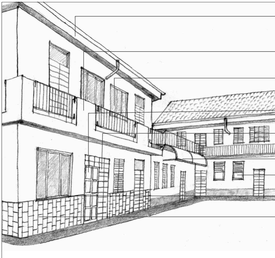
Sostituzione della copertura esistente con struttura in cls, con sottogronda di spessore e aggetto non proporzionati all'edificio
